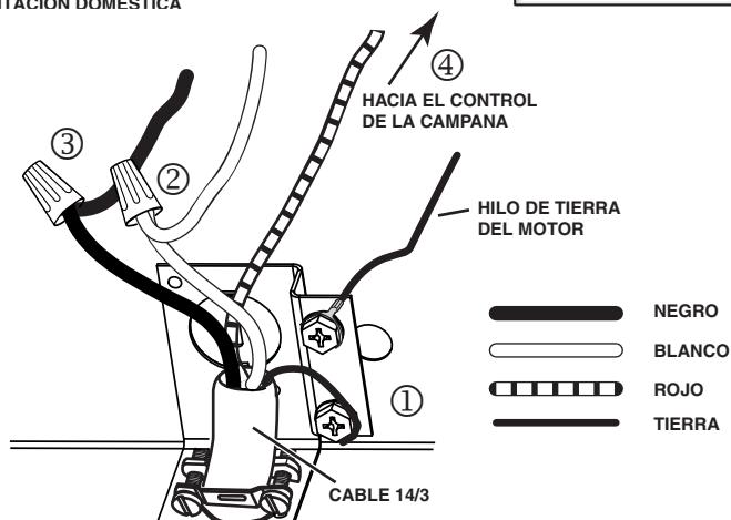
**NOTA:** Prevea una longitud adecuada de cable 14/3 para conectar el hilo ROJO en la parte delantera de la campana.
