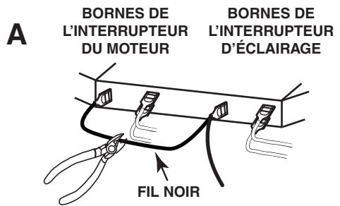
**B** Installer un capuchon sur le fil NOIR connecté à la borne de l'interrupteur de l'éclairage. Connecter le fil ROUGE du câble 14/3 au fil NOIR provenant de l'interrupteur du moteur, à l'aide d'un capuchon de connexion approprié.
