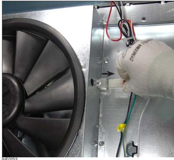
④ Utilice una llave de tubo de 11/32" para retirar las 6 tuercas que sujetan la cámara del ventilador al conjunto de la campana (2 tuercas en la parte trasera interior y 2 tuercas por lado); use luego un destornillador Phillips no 2 para quitar los dos tornillos de las esquinas delanteras. Véase en la imagen de abajo la ubicación de las tuercas y los tornillos. Saque la cámara del ventilador desde el conjunto de la campana y póngala a un lado con sus tornillos y tuercas de sujeción.
