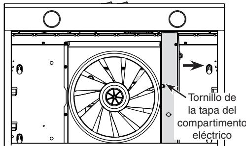
③ Desenchufe el conector del ventilador del mazo de cables principal.
