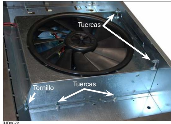
⑤ Retire y ponga a un lado los 4 tornillos delanteros que sujetan la placa dobrada a la campana.
