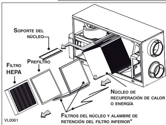
\*Alambre de retención del filtro inferior solamente para el modelo H50100E
