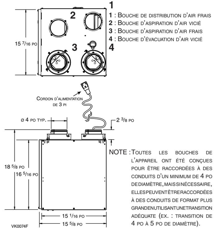
NOTE : TOUTES LES BOUCHES DE L'APPAREIL ONT ÉTÉ CONÇUES POUR ÊTRE RACCORDÉES À DES CONDUITS D'UN MINIMUM DE 4 PO DE DIAMÈTRE, MAIS SI NÉCESSAIRE, ELLES PEUVENT ÊTRE RACCORDÉES À DES CONDUITS DE FORMAT PLUS GRAND EN UTILISANT UNE TRANSITION ADÉQUATE (EX. : TRANSITION DE 4 PO À 5 PO DE DIAMÈTRE).
